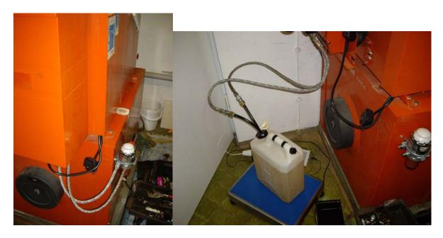
Die Kraftstoffleitungen wurden abmontiert, verlängert und an einen externen transparenten 10 Liter Kraftstoffbehälter (Kanister) angeschlossen. Der Kraftstoffbehälter wurde während der gesamten Teststellung auf einer digitalen Waage platziert.
